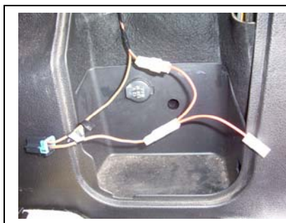
Dauerplus von Kofferraum- Steckdose mit Kabelbrücke versehen
