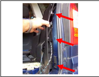
Rechte Seitenverkleidung etwas abziehen, 3 Clips, Blinkerstecker verlegen
