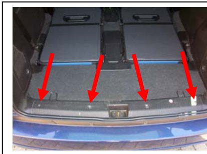
Heckblechverkleidung demonstrieren, 4 Schrauben
