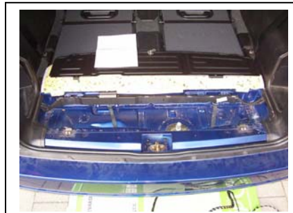
Bodenverkleidung nach vorne klappen
