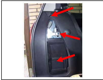
Linke Seitenverkleidung abschrauben, 3 Schrauben
