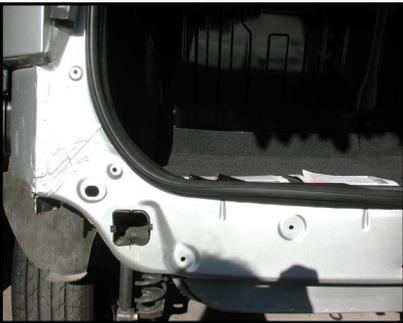
Abbau der Stoßstange und des Grundträgers (Pralldämpfer)
