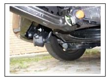
Ansicht seitlich von unten der montierten Anhängerkupplung
