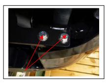
Beide Träger (2) mit beiliegenden Schrauben V an Träger(1) montieren L+R
