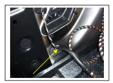
Kabel für den 13pol. Stecker durch den vorh. Auslass stecken
