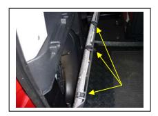
Seitenverkleidung demontieren um das Kabel zu verlegen
