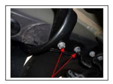
Vor. Schrauben (Kennz. X) ausschrauben und mit Trägern (2) montieren L+R
