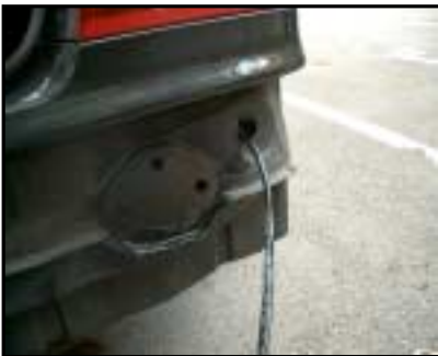
Anschluss des E-Satzes, Kabeldurchführung
