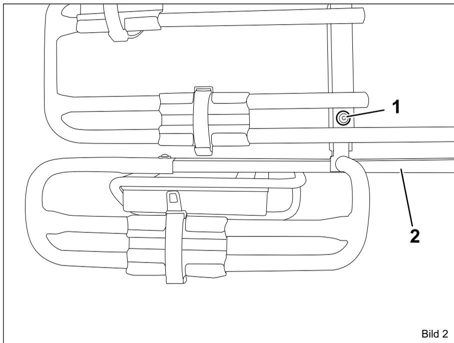
Die Schraube (1) demontieren. Die Leuchtenhalterung (2) herausziehen.
