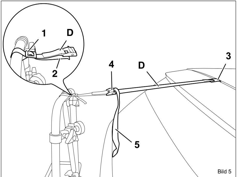
Die Zugentlastung (D) durch die Schnalle (1) ziehen und um die Haltestange legen. Das Ende (2) der Zugentlastung wieder durch die Schalle (1) ziehen und die Überlänge abschneiden. Die Schnittkante mit einem Feuerzeug versiegeln.
