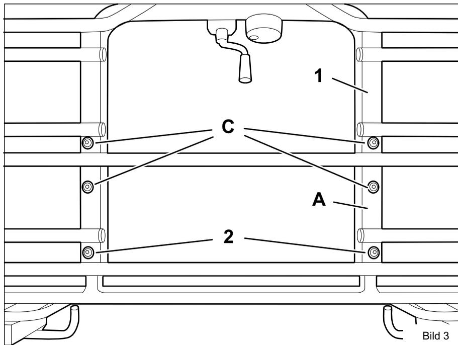
Die Erweiterung für viertes Rad (A) unter der Radschiene des Fahrradträgers (1) einfädeln. Mit den Schrauben (C) und (2) festschrauben.
